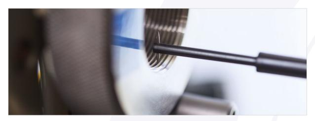
oder Prüfstiften und die klassischen Verfahren zur Bestimmung der Steigung auf Abbe-Längenmessern, lassen nur bedingt Rückschlüsse auf die reale Gewindegeometrie zu.
