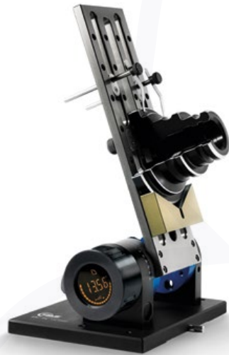
Ringaufnahme WSE-300 mit digitaler Winkelanzeige – Beispiel für Messrichtung geneigt
